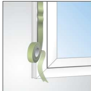
Bild 3: Stumpfstoß bei der Fenstermontage
